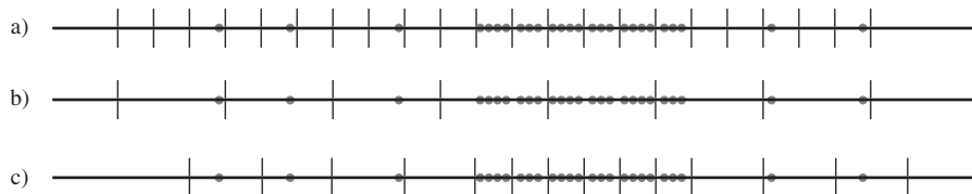
Figura 1.9 Selección de intervalos de clase para un conjunto “alargado” de puntos: a) intervalos angostos de ancho igual; b) intervalos amplios de ancho igual; c) intervalos de anchos diferentes.
